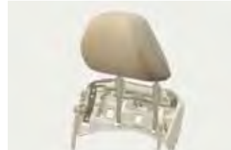
En choques desde atrás, los apoyacabezas activos delanteros* reducen el impacto sobre el cuello. * Algunas 2.4 EX con tapizado de cuero
